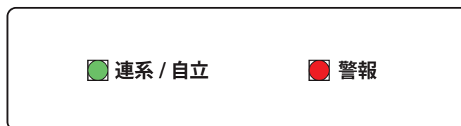
ハイブリッドパワーコンディショナのLED表示[表示パネル拡大]
