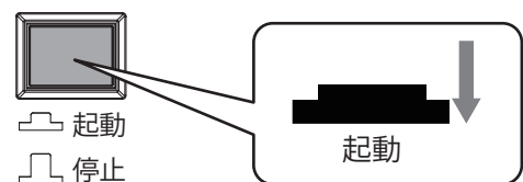
図④【パワーコンディショナ 非常停止ボタン】
