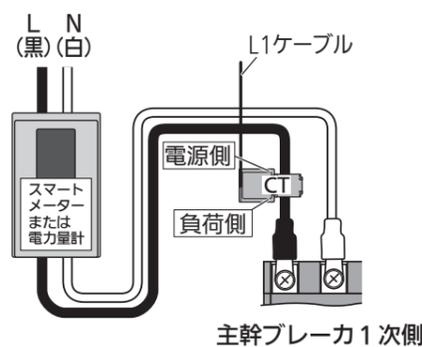
L1側の主幹CTは表示に当たってL相に接続してください。L2側の主幹CTについては、CTをつけた状態で住宅盤内の電線に接しない場所にまとめておくか、CTを取り外して何も接続しないようにしてください。
