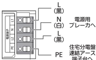
注) プレーカ側で共締めするなどして、両方の L 端子に電圧が供給されるように配線ください。系統から単相 3 線が来ている場合は、必ず単相 3 線接続してください。(正しく接続しないと正確な電力値を計測できません)
