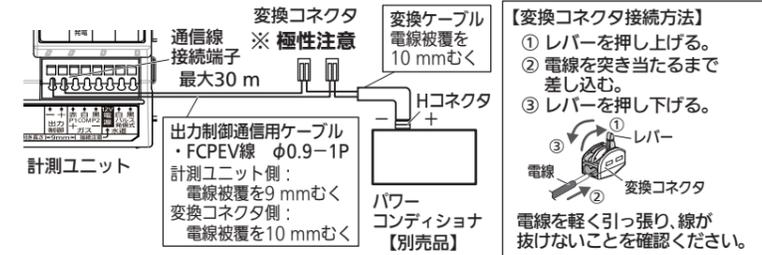
※ パワコン変換ケーブルセットを用いた接続と MODBUS 接続を混在して計測ユニットに接続しないでください。パワーコンディショナが認識されません。また、当社製「パワコン一括制御リモコン【別売品】」を使用される場合は、パワーコンディショナを介して接続してください。(詳細は下記「手順6」を参照) 変換コネクタや変換ケーブルが動いて外れないように、パワーコンディショナ内部で結線を固定し、電力線から離して接続してください。通信線の接続時、接続機器の強電部へ接触しないように十分注意してください。特に、変換ケーブルの被覆を 10 mm 以上むかない、配線クズ・配線ヒゲが発生しないよう注意してください。(詳細はパワーコンディショナの説明書をご参照ください)
