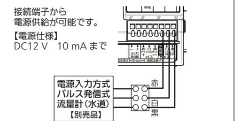
(オープンドレイン出力方式のパルス発信式流量計の場合)
