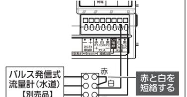
※ パルス発信式流量計が 3 線式の場合は必ず 2 線式に変更し、結線してください。
