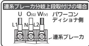
ガス発電用/燃料電池用ブレーカ (プラグイン端子タイプ)
