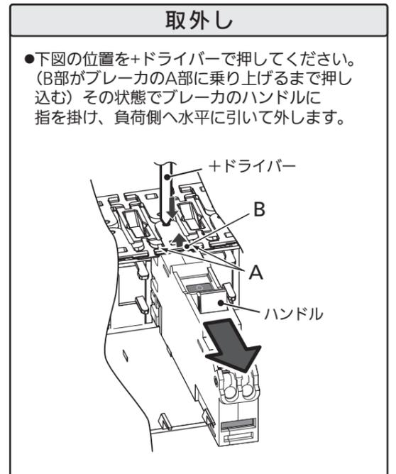
**端子台に接続のブレーカの取付け・取外し(LJP62322の場合)**
