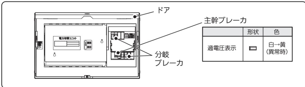
■電気が切れたときの処置 【主幹ブレーカ動作時、ハンドルの繰返し投入は避けてください】
