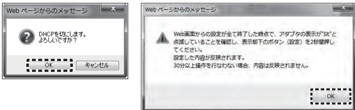
蓄電池ネットアダプタの設定・エラー表示器が”St”の点滅に変わりますので5分以内に設定ボタンを2秒以上長押しします。
