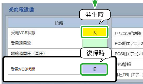
一括監視画面 受変電設備エリア ※表示テキストと表示色の変更が反映されます。
