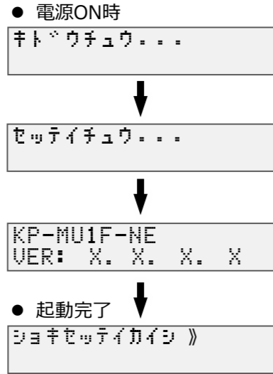
図6. 計測ユニット起動時の表示部状態
