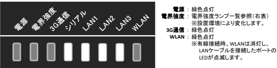
図2 Wi-Fiルータ起動時のLEDランプ状態(正常時)
