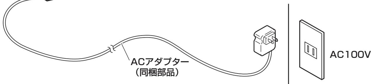
設置後、ACアダプターをコンセントに挿入すると、起動ロゴを表示したのち、メイン画面を表示します。通信設定が完了していない場合は、ネットワーク設定の画面を表示します。各種設定は必要に応じて行ってください。(18～46ページ)
