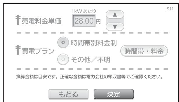
**時間帯別料金制** 時間帯ごとに電気料金単価が異なる契約です。オール電化の家庭で一般に契約されています。朝晩、昼、夜の時間帯と単価を設定します。また、深夜電力プランの場合は、昼と夜の時間帯と単価を設定します。
