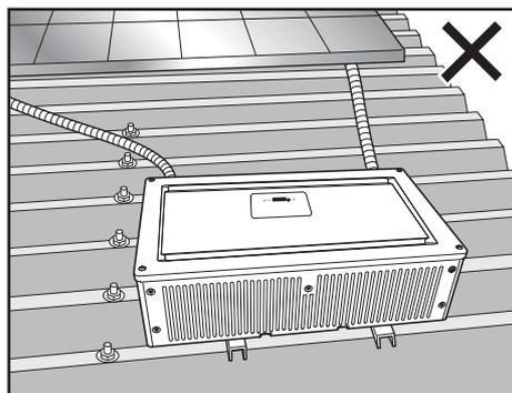
陸屋根/折板屋根上に平置きで設置
