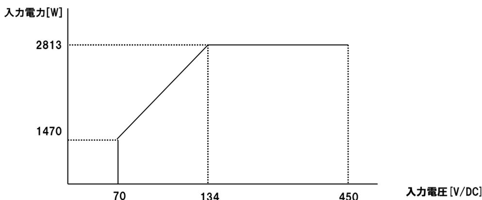
図 3-1 直流入力電圧と入力電力との関係
