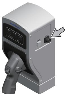
プラグホルダ右側面の「12V\_IN」に 12 V 電源ケーブルを接続してください。
