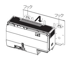
**2** パワーコンディショナ本体と取り付けベース板を本体固定用ねじ(M4×8)で固定する
