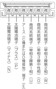
太陽電池からの直流線 (N/P 端子)、商用系統側の交流線3線(U/O/W 端子)、アース線(E端子)を接続します。
