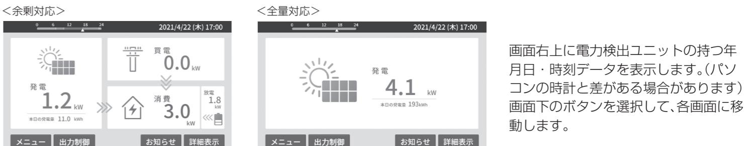
画面右上に電力検出ユニットの持つ年月日・時刻データを表示します。(パソコンの時計と差がある場合があります)画面下のボタンを選択して、各画面に移動します。
