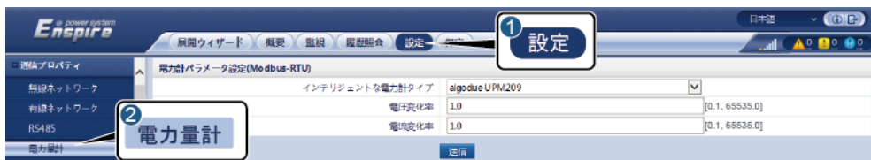
図 6-24 電力量計のパラメータを設定する
