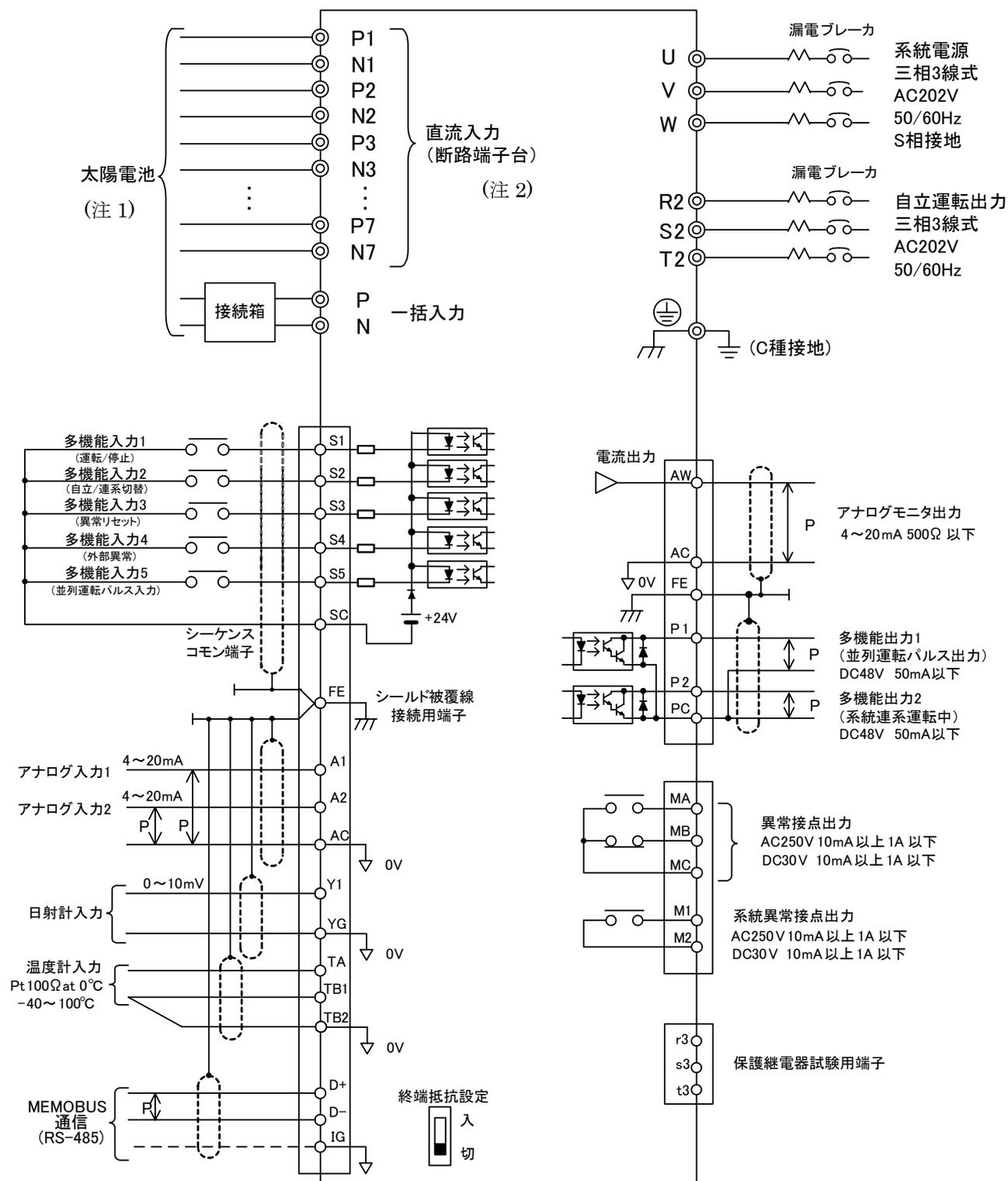
(注 1) 太陽電池の直列数は、太陽電池の最大出力動作電圧が 400~450V 程度となる直列数を目安に選定してください。
