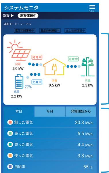
システムの構成機器の動作状態、および電気の流れをグラフィック表示し、システムの運転状態が確認できます。
