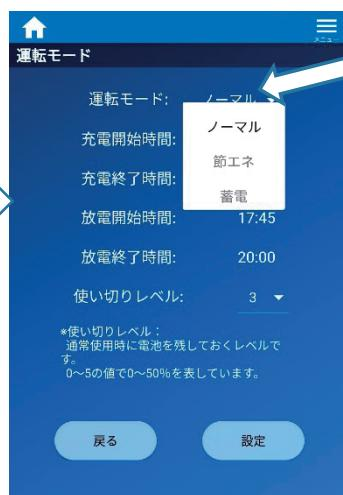
②運転モードのセレクトボックスをタップして、運転モードを選択します。
