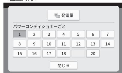
選択したパワーコンディショナの発電量をグラフで表示します。
