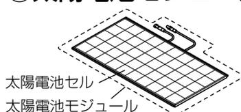
太陽光エネルギーを直流電力に変える働きをします。太陽電池セルが集まり、1枚の太陽電池モジュールになります。太陽電池モジュールを複数枚組み合わせて、屋根に設置した状態を太陽電池アレイと呼びます。
